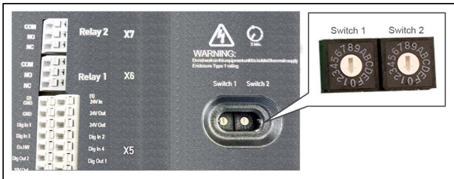
Abb.: 9 Parametereinstellung über Drehschalter“
